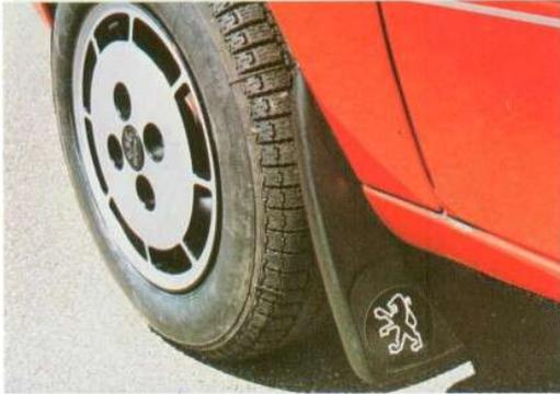
**Schmutzfänger** mit Löwen-Emblem vorne schützt die Karosserie vor Steinschlag und starker Verschmutzung. Befestigung ohne zu bohren.
